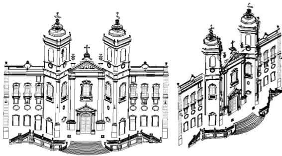
Figure 4. CAD 3D wireframe model of the Igreja de Nossa Senhora da Conceição da Praia, Bahia.
