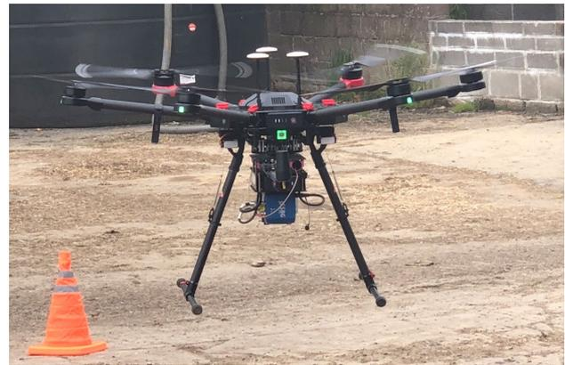
Figure 5. The Matrice 600 Pro SUA carrying the Robin Mini.
