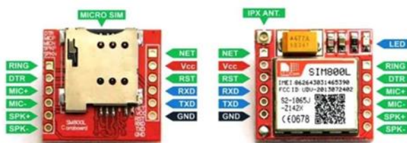
Figure 2. SIM800L Mini GSM/GPRS module.
